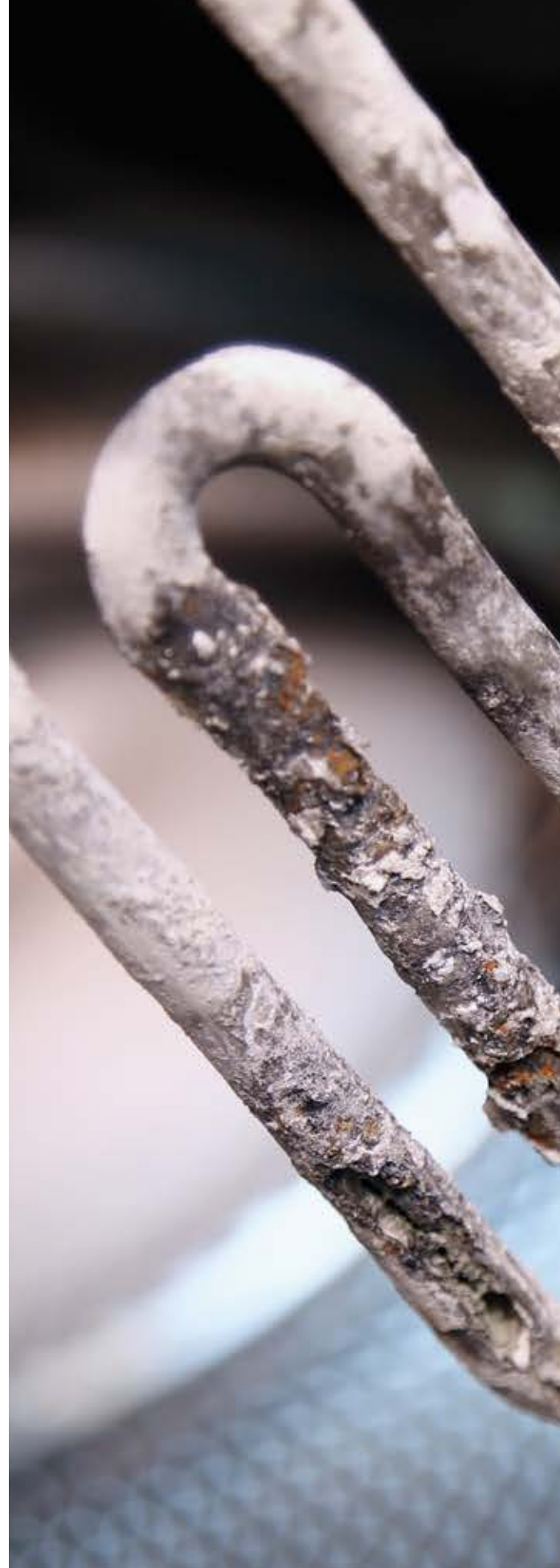
Ejemplos de acumulación de cal...
